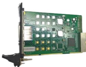
**RX38101** 是一种智能 PXI 多端口串口通讯模块，可由软件配置为 RS232/422/485 电平模式。采用专用串口芯片设计，可以方便灵活进行物理电平控制，其每个串口控制器每个都支持高达 6Mbps 的数据速率，此外，RX38101 为标准 3U PXI 单宽模块，允许将板安装在任何 PXI 及兼容插槽中。
